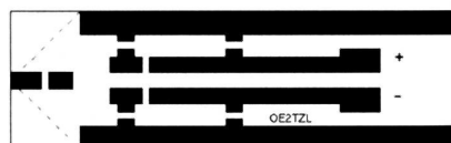
Obr. 2. Obrazec spojů vf sondy (v originální konstrukci byl použit materiál FR-4)
