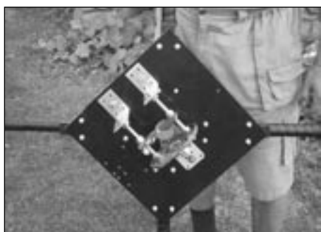
Obr. 4. Základová deska s anténním úchytem a její vyztužení L-profilů. Doporučuji „zrcadlově“ umístit další dva L-profilů.
