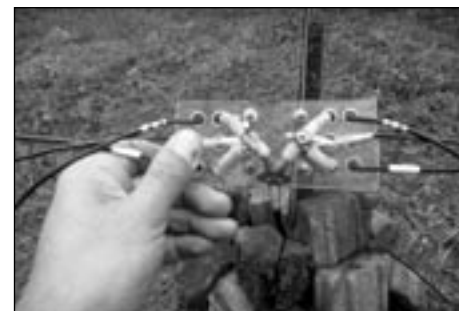
Obr. 6. Praktické provedení nesymetrického napáječe pro modifikovanou verzi VK2ABQ včetně plexi destičky pro uchycení prvků antény.
