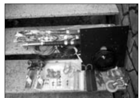
Obr. 2. Vybavení materiálem na zkoušení knoflíkovky. Ve výbavě nechybí 4 rybářské pruty, velké knoflíky na izolátory a spojovací prvky z dětské stavebnice MARS.
